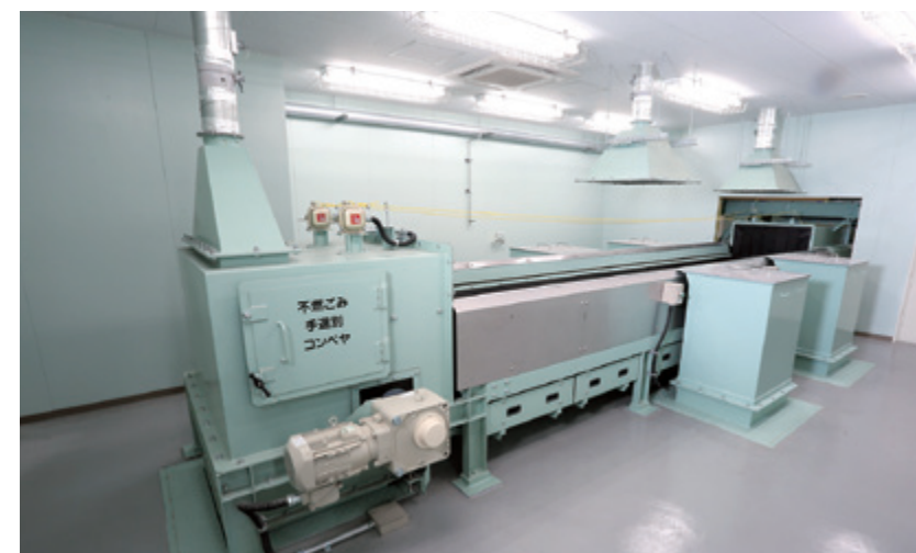
2階手選別室(令和2年2月撮影) 不燃ごみの手選別室です。不燃ごみから小型家電、有害物・危険物等を手作業により分別します。
