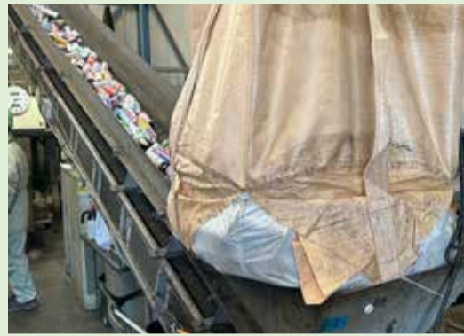
コンベヤにて無害化処理機に投入されるスプレー缶
